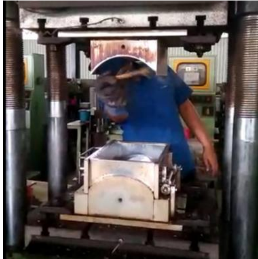
Gambar 6. Proses hidrolis menggunakan matras untuk mencetak kampas
