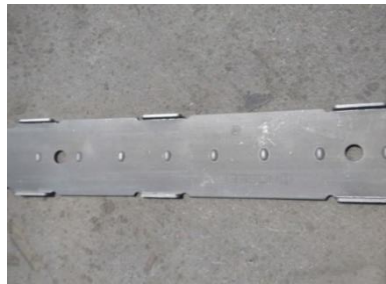
Gambar 4. Elemen brake shoe : daun
