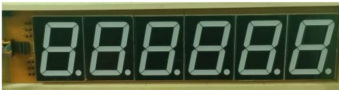
Gambar 6. Enam 7 Segment 4 Inch yang sudah disusun
