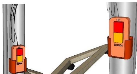
Gambar 13. Tempat penyimpanan saklar on/off mesin penarik
