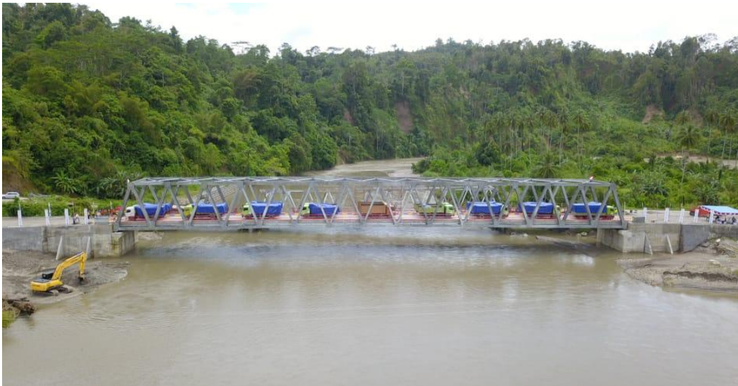
Gambar 14. Uji Pembebanan Jembatan X di Pulau Seram Provinsi Maluku Sumber : (BPJN Provinsi Maluku, 2021)
