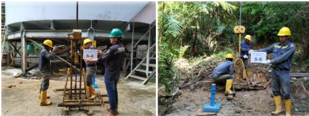
(b) Dokumentasi pada Saat Uji Sondir (CPT)
