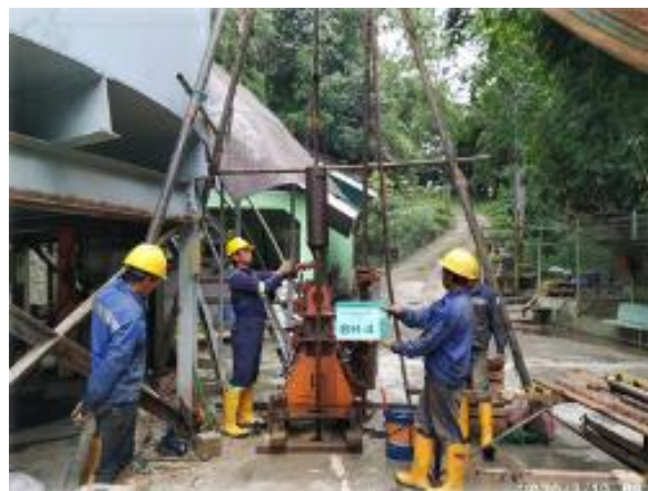
(a) Dokumentasi pada Saat Uji SPT dan Pengambilan Sampel Tanah
