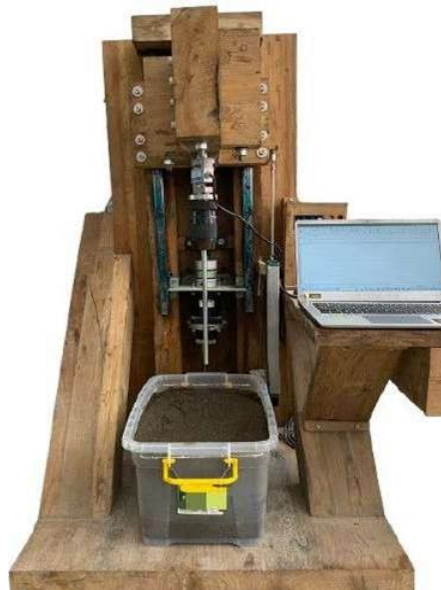
Gambar 3. Alat Uji Tekan Skala Kecil ( AIC Innovation )
