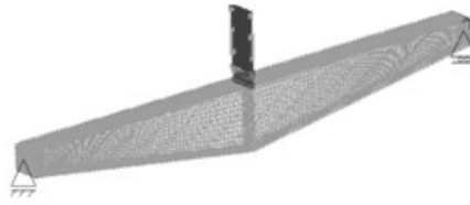
Gambar 6. Model Dengan Beban Terpusat Pada Flens Atas
