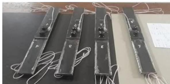
Gambar 12. Pemasangan Strain Gauge Pada Benda Uji
