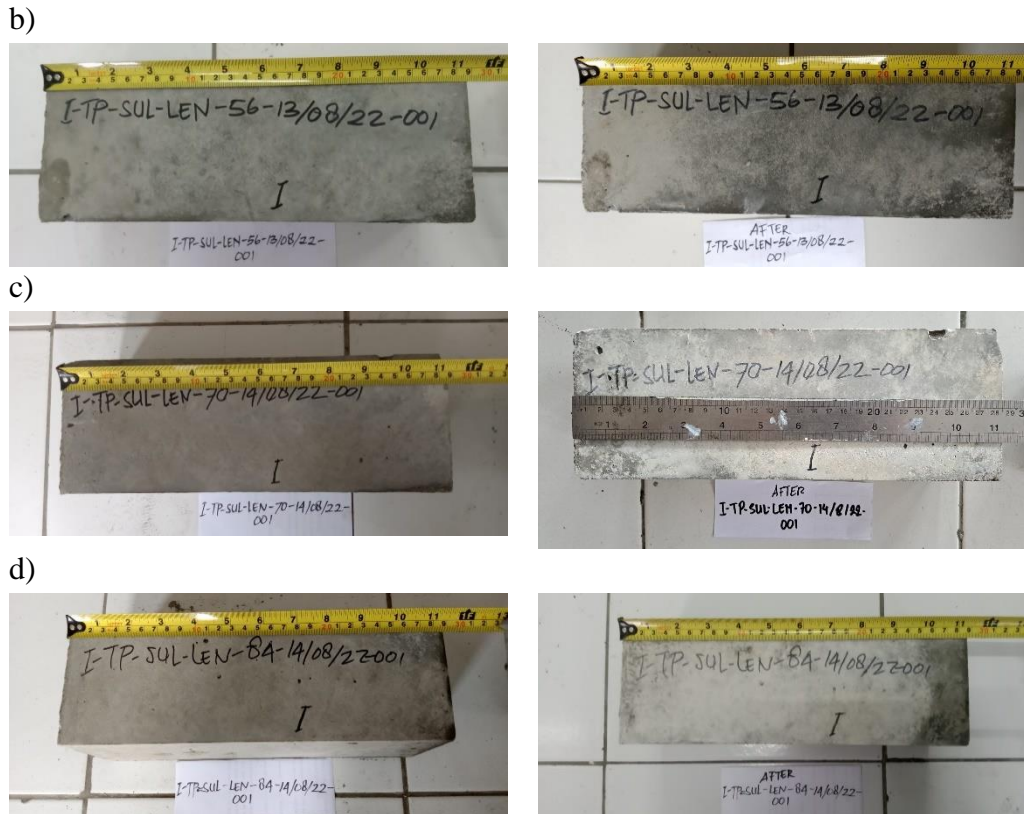
Gambar 10. Karakteristik Visual Benda Uji Semen Tipe I Tanpa Proteksi (Lanjutan) b) Lama Rendam 14 Hari, b) Lama Rendam 28 Hari, c) Lama Rendam 42 Hari, d) Lama Rendam 56 Hari
