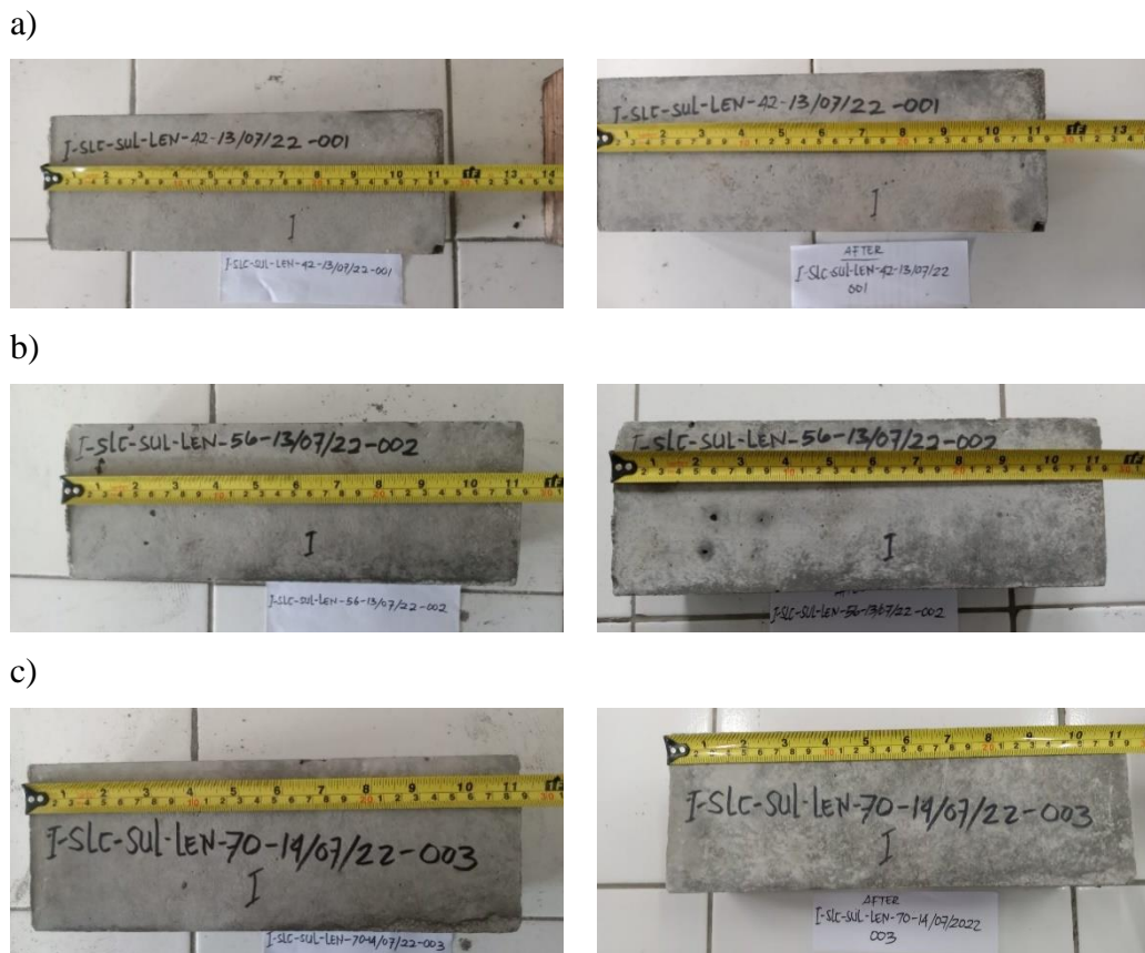
Gambar 13. Karakteristik Visual Benda Uji Semen Tipe I dengan Silica fume a) Lama Rendam 14 Hari, b) Lama Rendam 28 Hari, c) Lama Rendam 42 Hari
