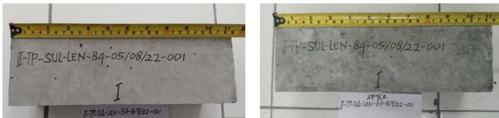
Gambar 15. Karakteristik Visual Benda Uji Semen Tipe II Tanpa Proteksi (Lanjutan) a) Lama Rendam 14 Hari, b) Lama Rendam 28 Hari, c) Lama Rendam 42 Hari, d) Lama Rendam 56 Hari
