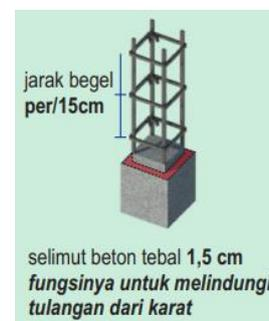
**Gambar 15.** Jarak Sengkang Kolom
