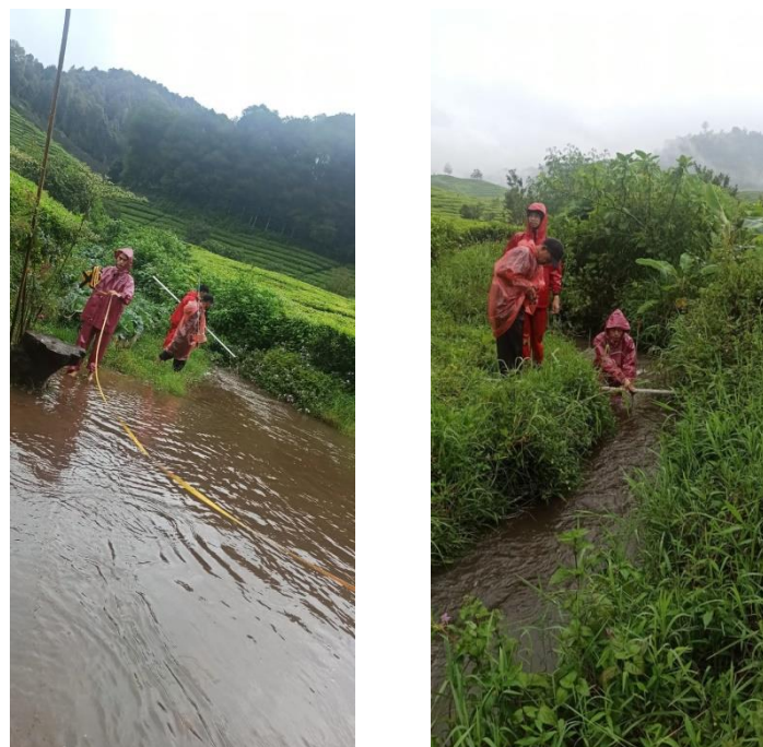
Gambar 6. Pengambilan Data Kecepatan Aliran dan Pengukuran Penampang Sungai Saat Curah Hujan Tinggi
