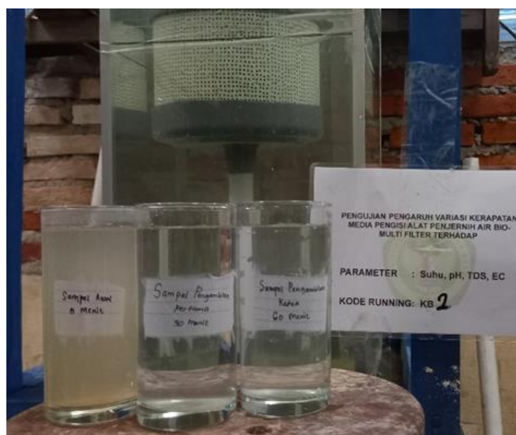
Gambar 9. Contoh sampel air hasil pengolahan pada alat penjernih air Sarang Tawon dengan ketebalan media filter 4R/3 (4 inch) dengan kerapatan sabut kelapa 80%
