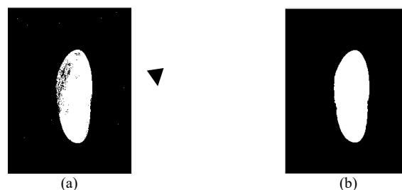
Gambar 6. Contoh (a) citra hasil segmentasi, dan (b) operasi morfologi
