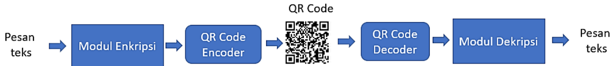
Gambar 1. Mekanisme kerja encoder dan decoder QR Code [1]
