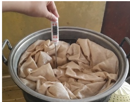
Gambar 3. Proses scouring pada kain rami (Sumber: Dokumen pribadi, 2023)
