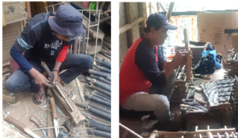
Gambar 8. Proses penyerutan tabung (a) dan penyetulan (b) dalam menghasilkan suara alat musik bambu Sumber: dokumentasi penulis, 2020
