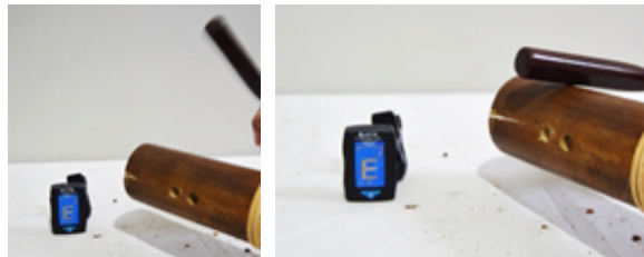
Gambar 11. Eksperimen pengetesan suara pada tabung bambu (a) dan ketika dipukul (b) Sumber: dokumentasi penulis, 2020
