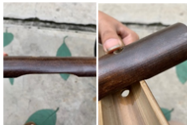
Gambar 7. membuat coakan yang lebih lebar pada dinding bambu (a) dan gabungan (b) Sumber: dokumentasi penulis, 2020
