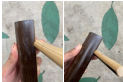
Gambar 6. Eksperimen sambungan dengan coakan (a) dan gabungan (b) pada bambu Sumber: dokumentasi penulis, 2020
