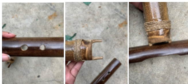
Gambar 5. Eksperimen sambungan bambu dengan membuat lubang (a) tonjolan (b) dan gabungan (c) pada dinding bambu
